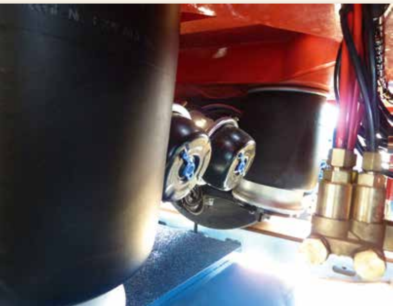
Viele kleine Details verbessern das Handling und schonen das Material, zum Beispiel die veränderte Lage der Bremszylinder.
