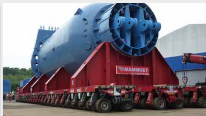
Transport des Reaktorbehälters im Forschungszentrum Jülich.
