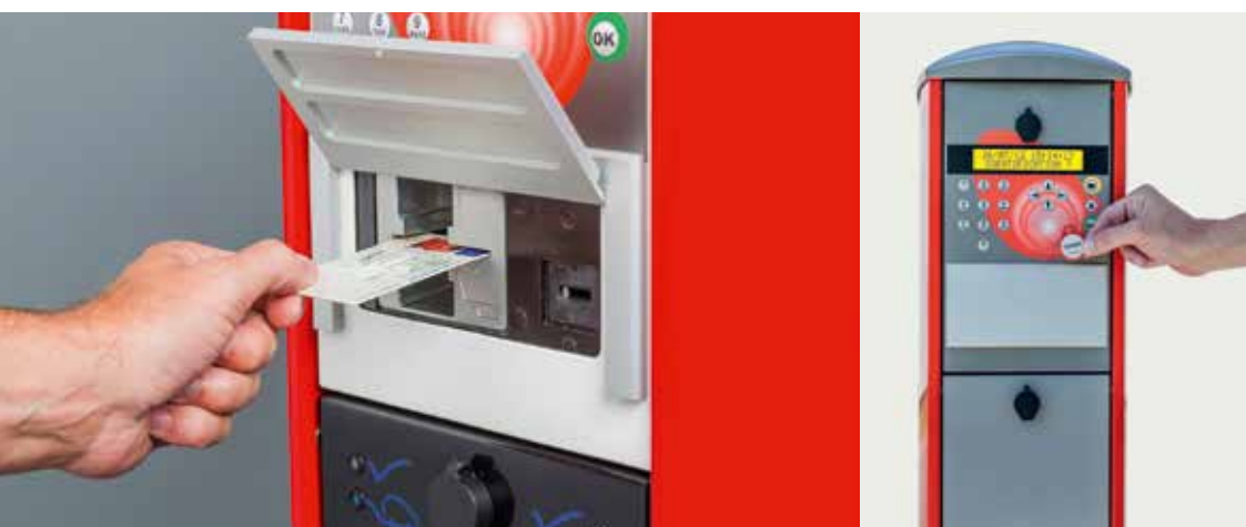
Beim Tankautomaten DiaLOG kann man sich je nach Konfiguration mit PIN, Tag oder Karte anmelden. Auch die Integration von bereits vorhandenen Identifizierungsmitteln, etwa aus der Zutrittskontrolle, ist möglich.
