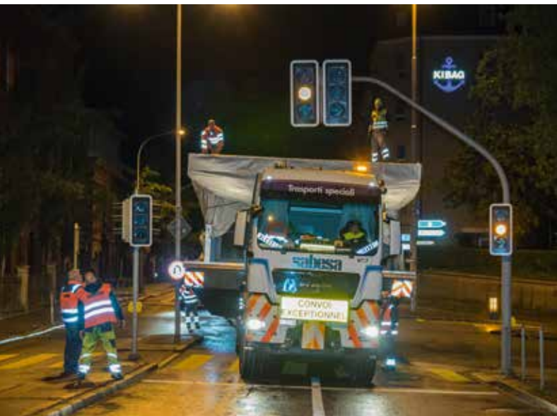
Durch die Konstruktion der Ampel wird es eng. Erst, nachdem der Transport ganz nah an die Mitte der Straße gefahren ist und durch Schrägstellen des Aufliegers kommt die empfindliche Ladung ganz knapp durch das Hindernis.
