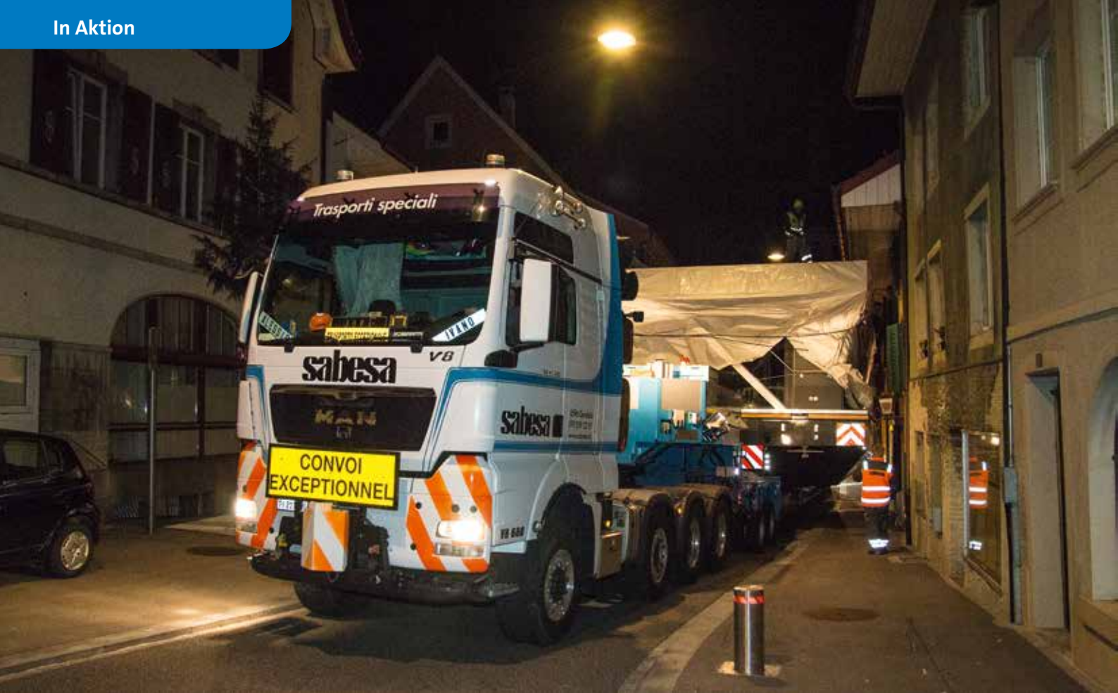
Die Poller werden mit der Einfahrt eines überbreiten Transports abgesenkt, damit sie nicht im Weg sind. Nur sollte man sich die Steuerung etwas überlegen, denn schon mehrmals sind die Poller, während des Transports wieder hochgefahren worden. Fatal, wenn dann etwas im Kesselbett Geladenes darüber steht.
