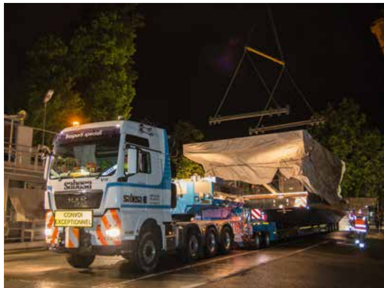
Angekommen! Der der Transport wird für die Entladung unter der Traverse positioniert.
