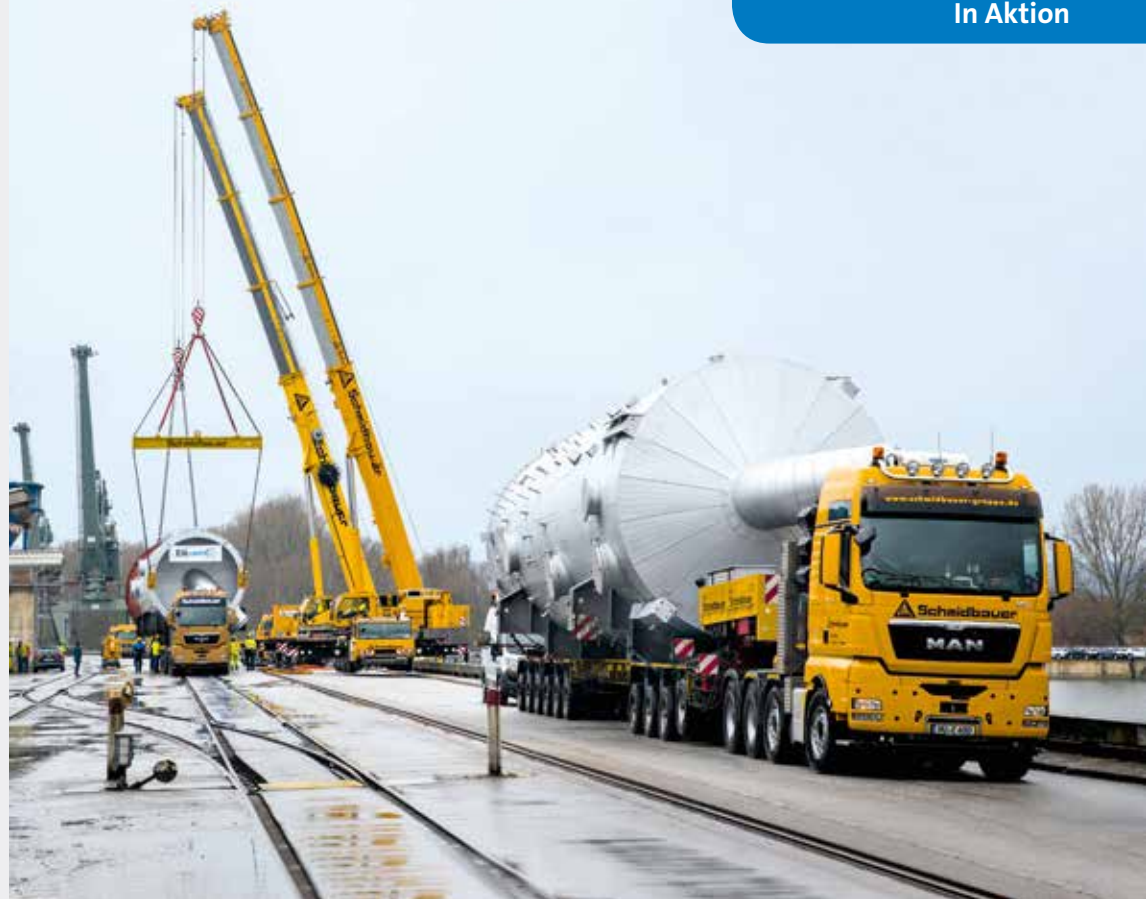
Nachdem zwei Mobilkrane die beiden Kolonnen im Binnenhafen vom Schiff auf die Zugmaschinen mit 10- und 15-Achs-Modulfahrwerken geladen hatten, konnte es losgehen.
