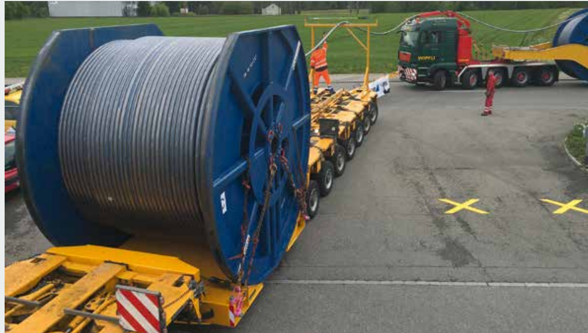
... so sieht es aus, wenn mit "verteilter" Last verfahren wird.
