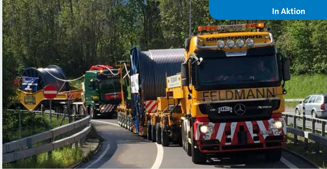
Man beachte das Seil der beiden Seilträger, die über das Dach der zweiten Transporteinheit geführt wird ...
