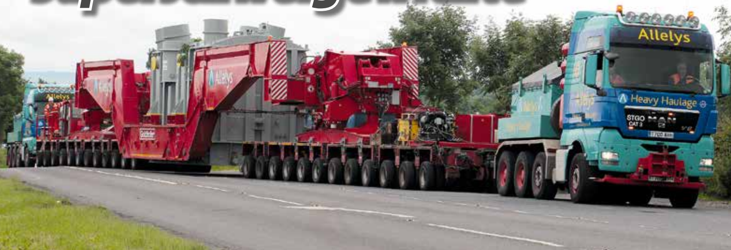
Der 212 Tonnen schwere Transformator auf der Kesselbrücke auf dem Weg zum Hafen.
