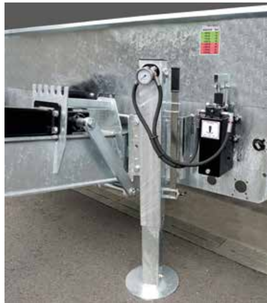
Hilfliche Unterstützung für den Fahrer: „Safety Control“ ist eine integrierte Stützlast-Messeinrichtung von Müller Mitteltal.
