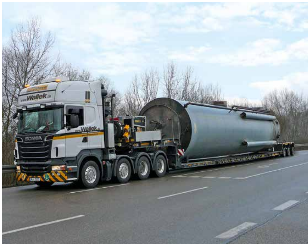
21 neue teleskopierbare MegaMAX-Tiefbett-Auflieger mit hydraulischer Federung und Pendelachse lieferte Faymonville an die BigMove-Gruppe.
