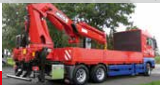
MAN-3-Achs-LKW Typ TGX 26.440 6x4 BL, mit MKG-Ladekran HLK 591
