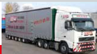
3- bis 5-Achs-Jumbo-Satteltiefelader, verbreiterbar und anhebbar
