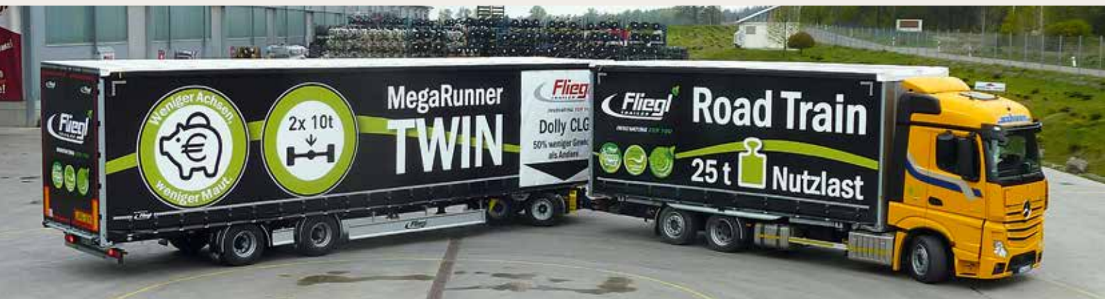
25,25 m-Kombination mit dem neuen Fliegl-Dolly CLG. Bei der Präsentation konnte das Kurvenlaufverhalten überzeugen. Und auch die Höhenbegrenzung von 4 m wird dank CLG eingehalten.
