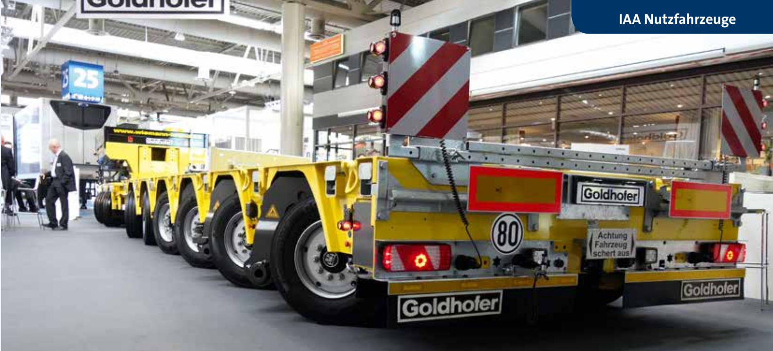
Unter 800 mm Blockmaß, eine Kombination aus nachlauf- und zwangsgelenkten Achsen sowie ein pfiffiges Konzept, die Dolly-Achsen einfach zu entfernen – das sind die Highlights dieser Goldhofer-Premiere. STM-Bild
