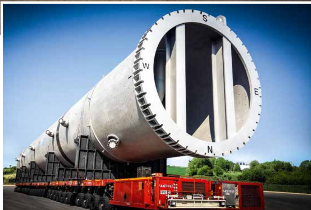
Jeder der beiden Hydrocracking-Reaktoren brachte es auf ein Gewicht von 1.535 t, eine Länge von mehr als 60 m, 8,5 m Breite und 10 m Höhe.
