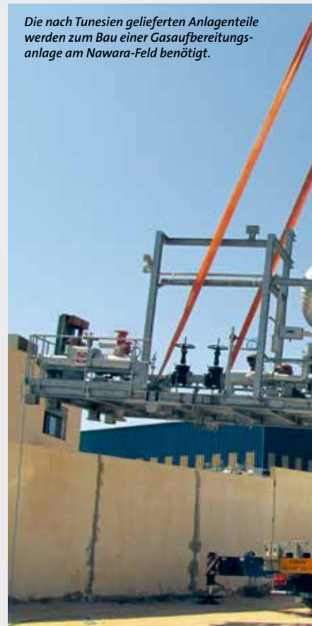
Die Ladung wurde durch Rhenus Project Logistics anhand genauer Berechnungen der auf dem Transport entstehenden Vibrationen auf den Aufliegern gesichert und fixiert.
