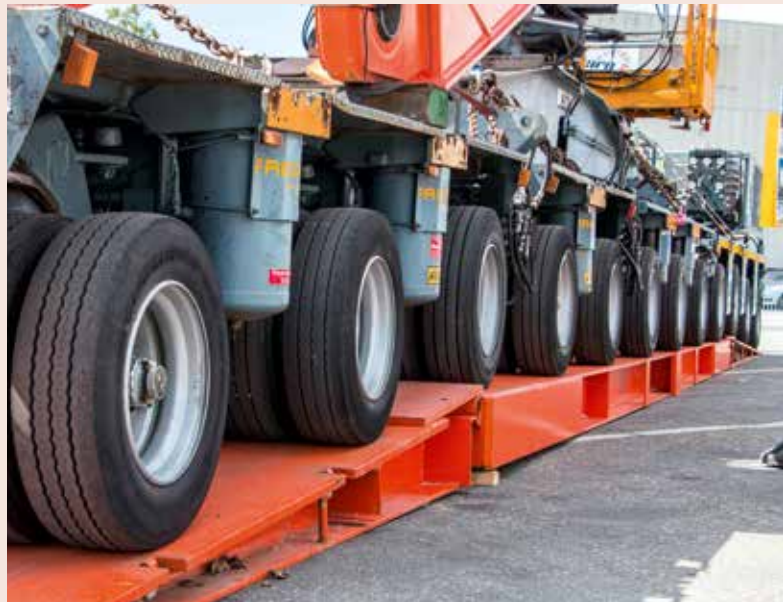
... erfordern etwas Achsausgleich auf der Fly-Over-Bridge.
