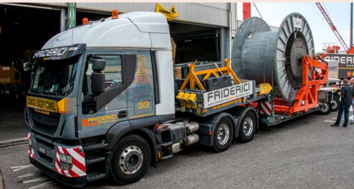
Iveco ist schon längere Zeit im Fuhrpark, neu ist dieser mit einer Seiltrommeldrehvorrichtung versehene Auflieger.
