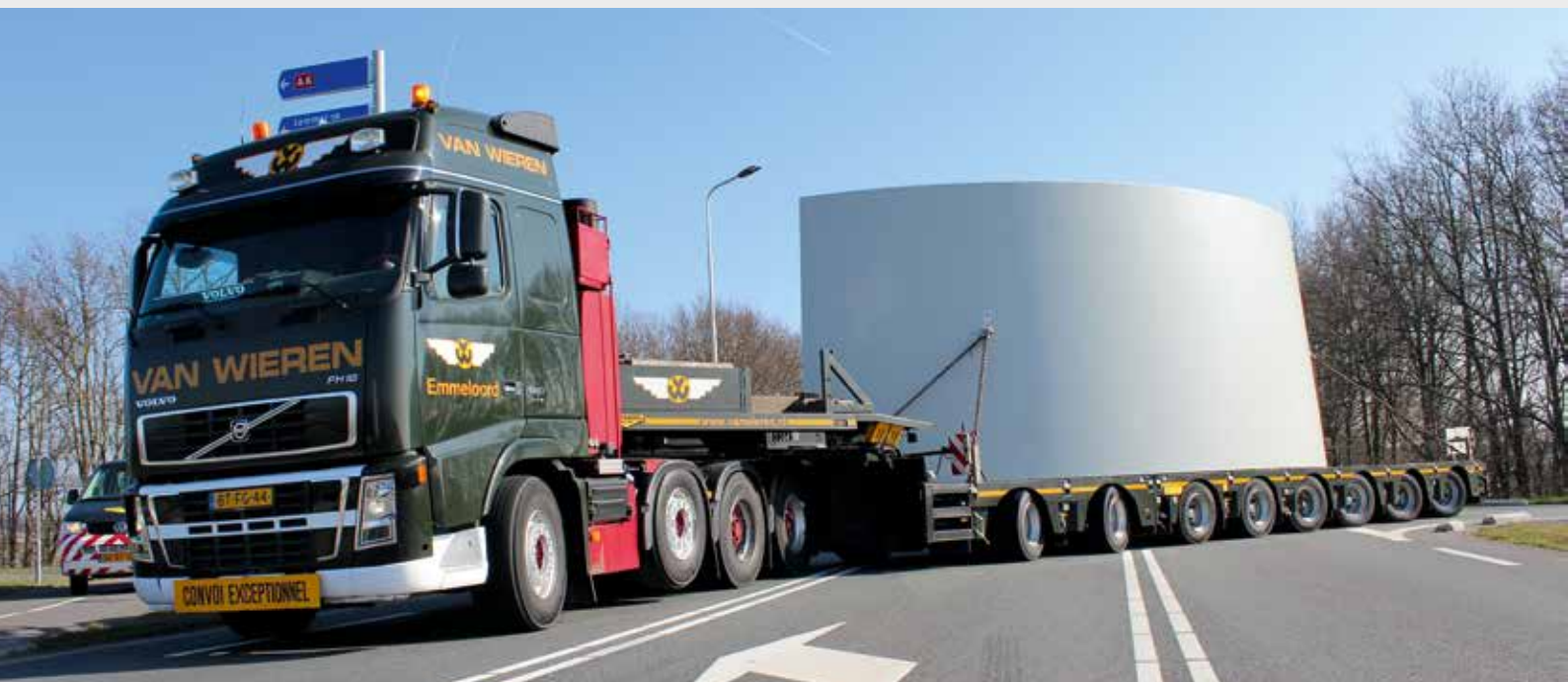
Transport einer Betonhalbschale für eine WEA.
