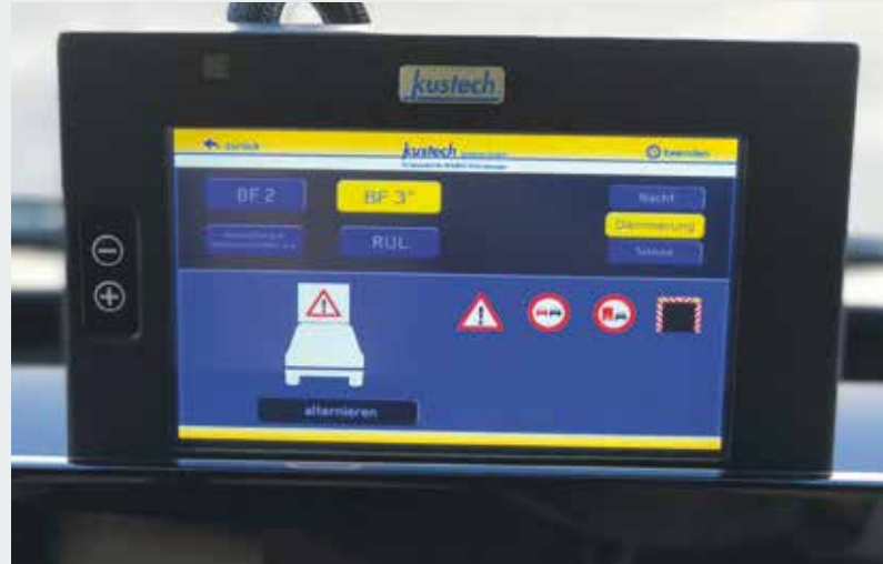
Die BF3 neo-WVZ-Anlage kann alle drei vorgeschriebenen Verkehrszeichen abstrahlen. Die integrierte Blackbox zeichnet automatisch die Position, Datum, Uhrzeit, die Funktionen und Zeichensetzung permanent auf. Diese Daten sind jederzeit, laut Merkblatt, vom Hersteller auslesbar.
