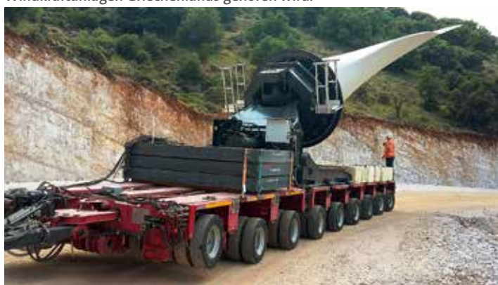
Hoch hinaus mit der FTV 550: Anipsotiki transportiert die bis zu 70 m langen Windrotorblätter auf die Höhen des Windparks Kassidiaris, der zu den größten Windkraftanlagen Griechenlands gehören wird. Fotos: Anipsotiki, Goldhofer
