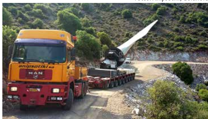
Hoch hinaus mit der FTV 550: Anipsotiki transportiert die bis zu 70 m langen Windrotorblätter auf die Höhen des Windparks Kassidiaris, der zu den größten Windkraftanlagen Griechenlands gehören wird. Fotos: Anipsotiki, Goldhofer
