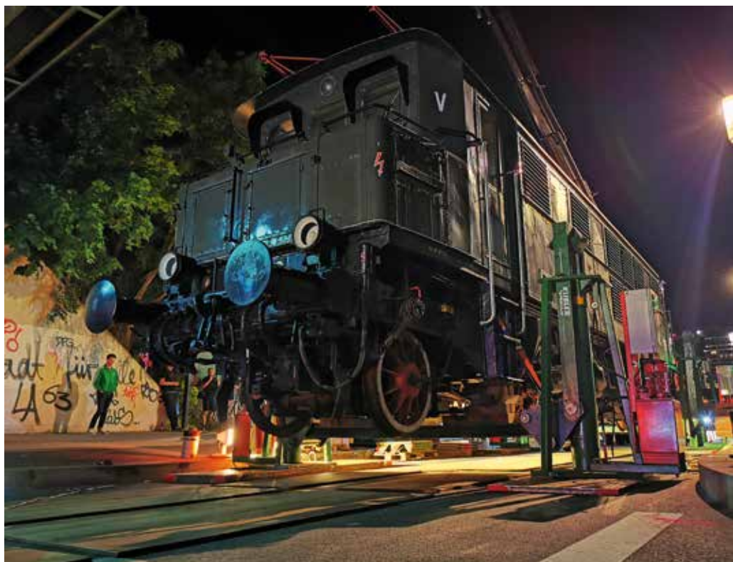
Hindernis: An einer zu niedrigen Unterführung muss die Lok nochmals abgeladen und auf provisorischen Schienen durch die Unterführung gezogen werden. Am Ende der Unterführung wird sie dann wieder auf den Trailer gehoben.
