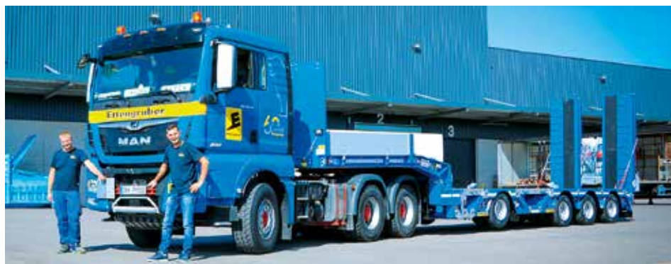
1+3 Achs MultiMAX Semi-Tieflader für das Bauunternehmen Ettengruber.
