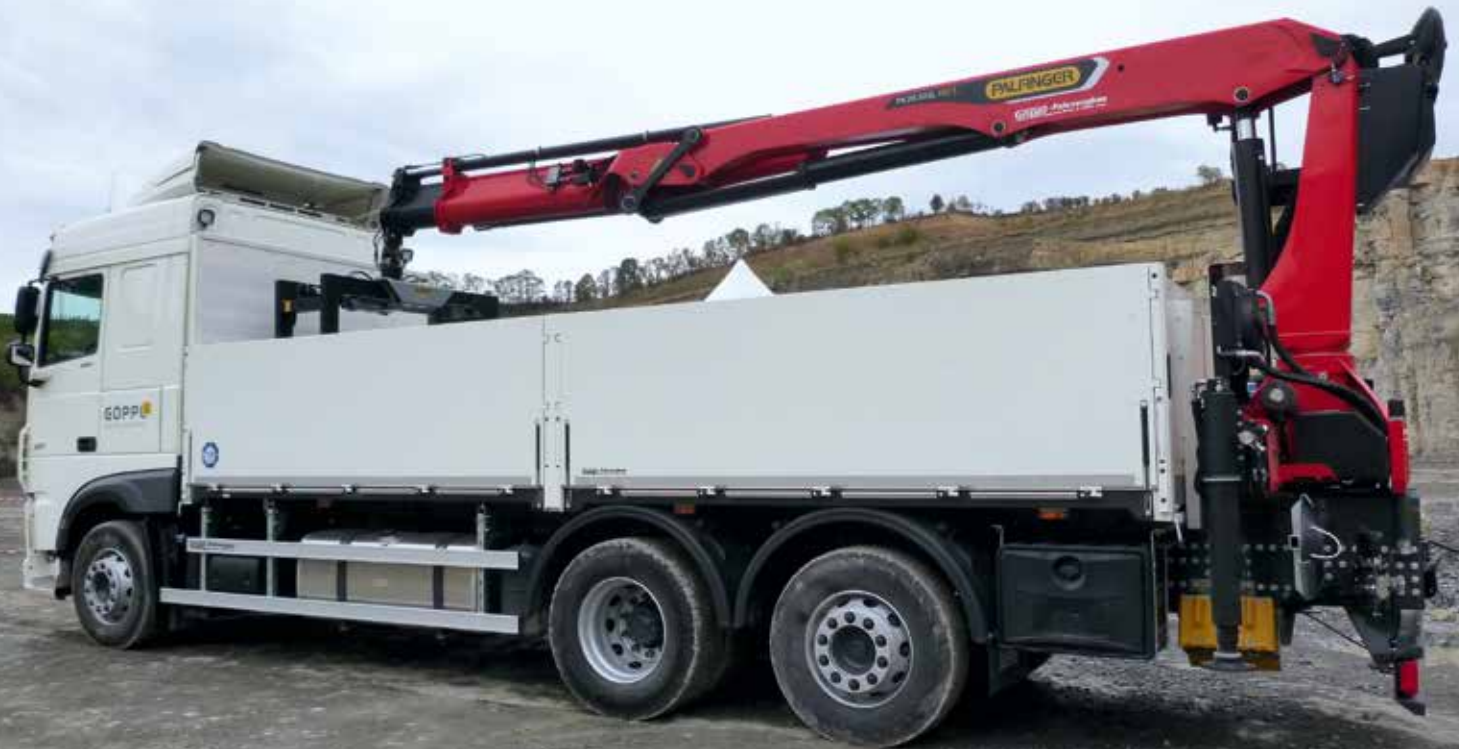
Der XF 480 FAN war beim Testdrive gleich zweimal vorhanden: Einmal als Testfahrzeug mit VDL-Abrollkipper und wie hier im Bild als Kundenfahrzeug mit aufgebaute Palfinger-Ladekran PK 20.501L TEC 3 für den Baustoffumschlag. STM-Bild
