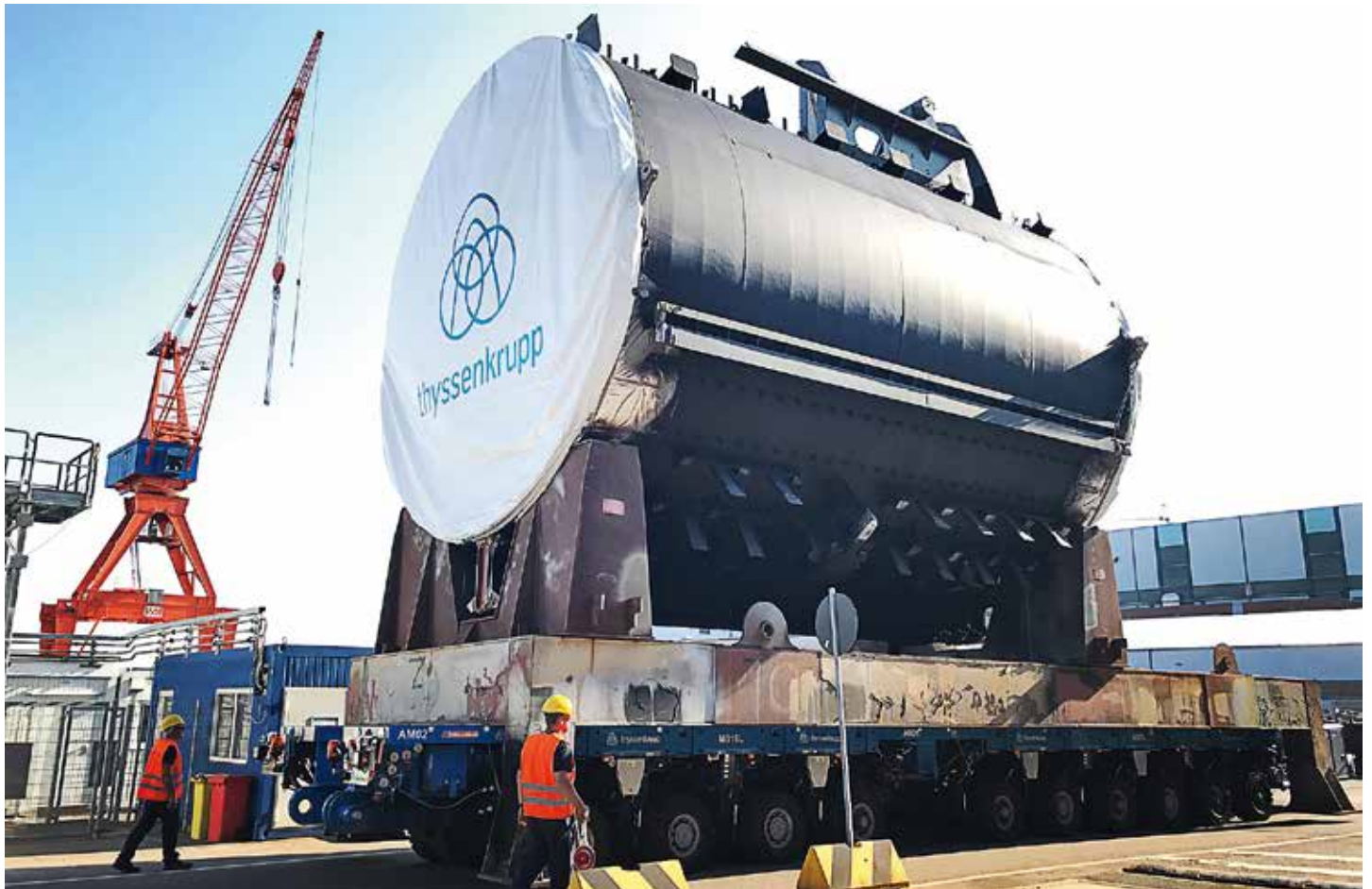
U-Boot-Sektion mit rund 100 t Gewicht und 20 m Länge auf Scheuerle SPMT SL.
