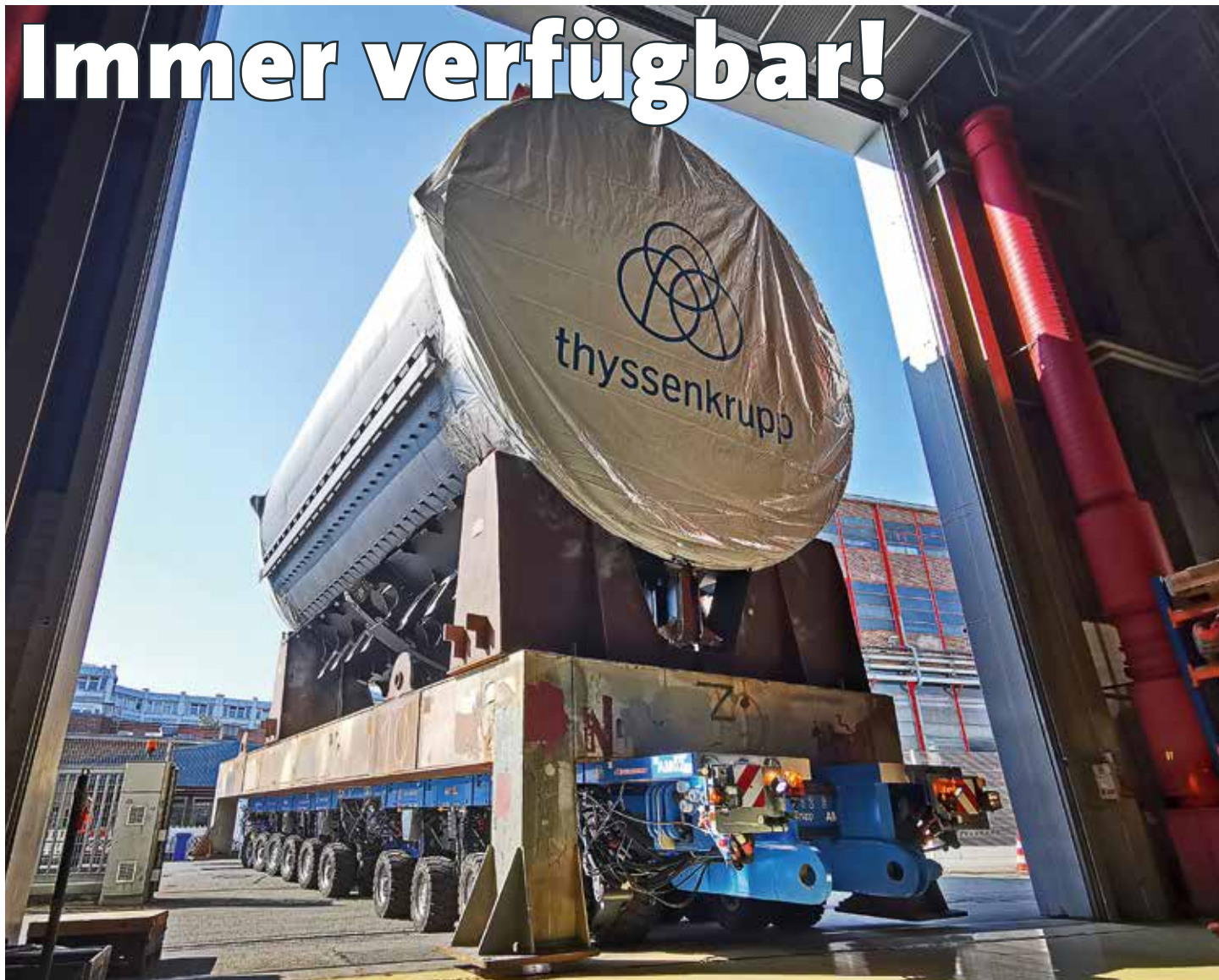
thyssenkrupp Marine Systems setzt in der innerbetrieblichen Logistik auf SPMT Achslinien von Scheuerle, um bis zu 250 t schwere U-Boot-Sektionen innerbetrieblich zu befördern.
