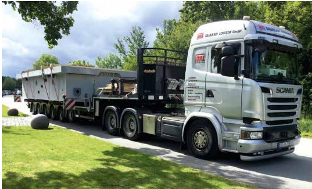
Ein Lkw mit 6-Achs-Semi-Tieflader aus der BKL Flotte transportiert einen 21 t schweren Pool. Für den mit 4,60 m überbreiten Transport stellten die Kranspezialisten die BF3- und BF4-Begleitung.
