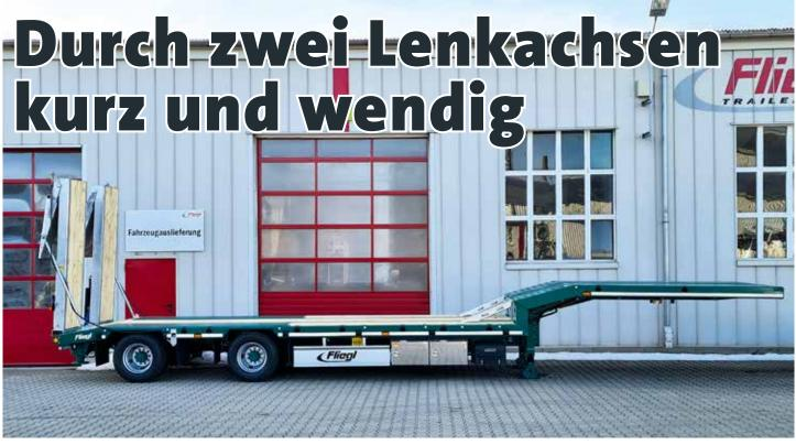
Der SZS 310 T von Fliegl verfügt über zwei hydraulisch zwangsgelenkte Achsen.
