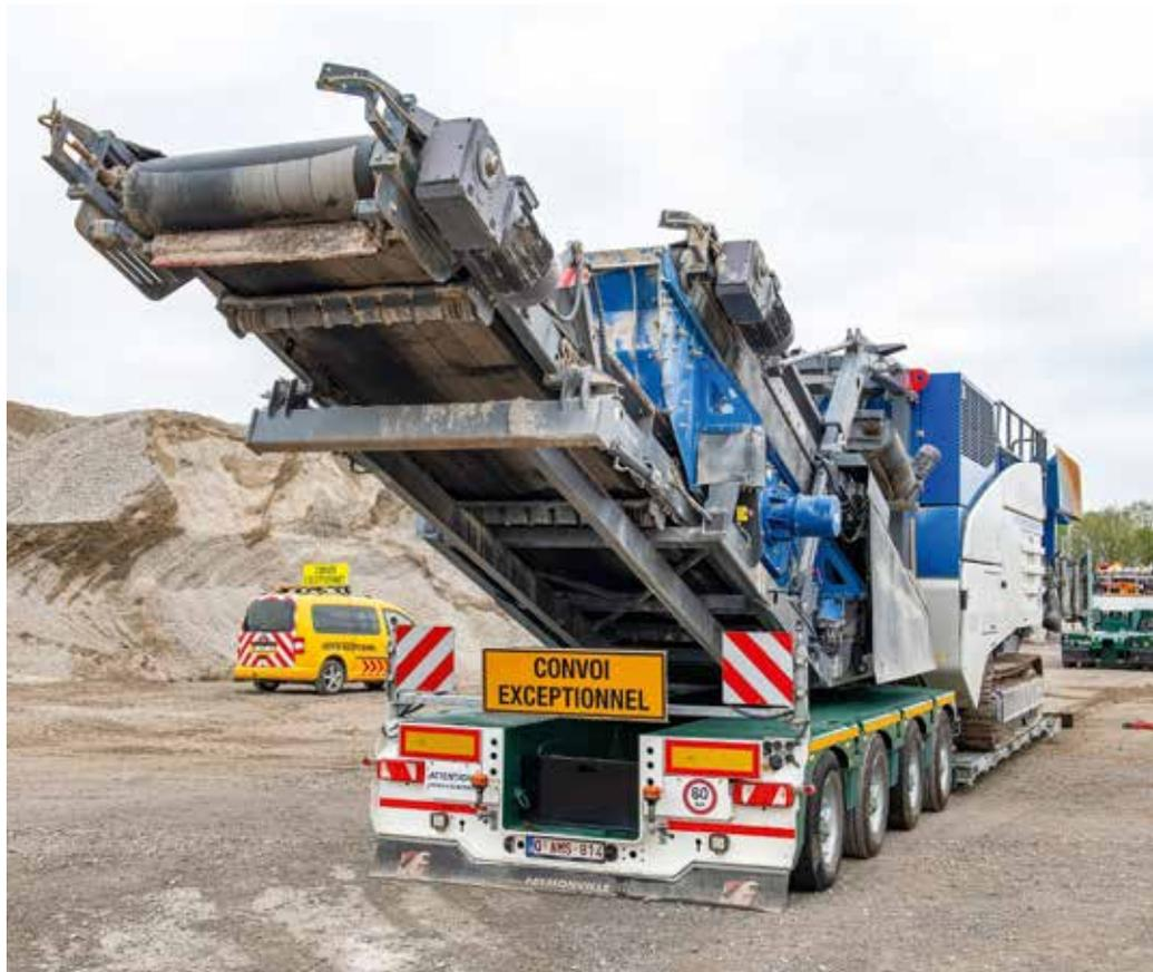
Der Brecher ist genau auf dem abgekoppelten Tiefbett platziert.
