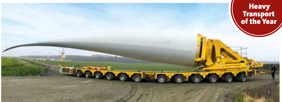
Zum Einsatz kam eine InterCombi Selbstfahrerkombination aus zwei Mal sechs Achslinien sowie der Rotorblattadapter G4.
