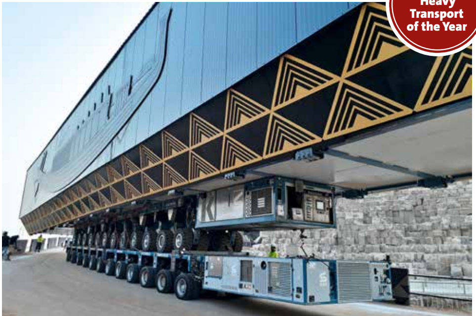
Die zwölf K24 Achslinien sind mit der kostbaren Fracht auf den zwölf K25 SPE Achslinien abgestellt.
