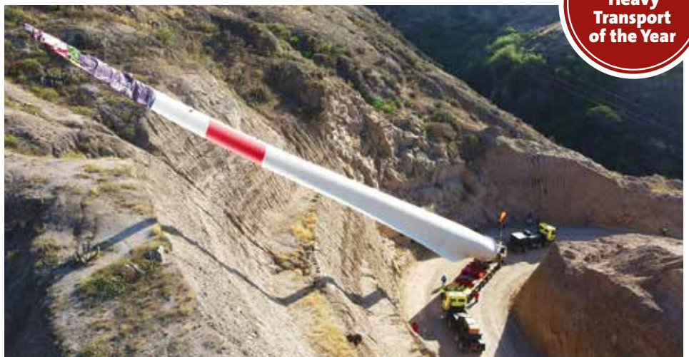
Aufgestellter Windflügel: so kann der Transport mit dem Goldhofer FTV 550 die Kurve mit dem Berg Rücken problemlos meistern.
