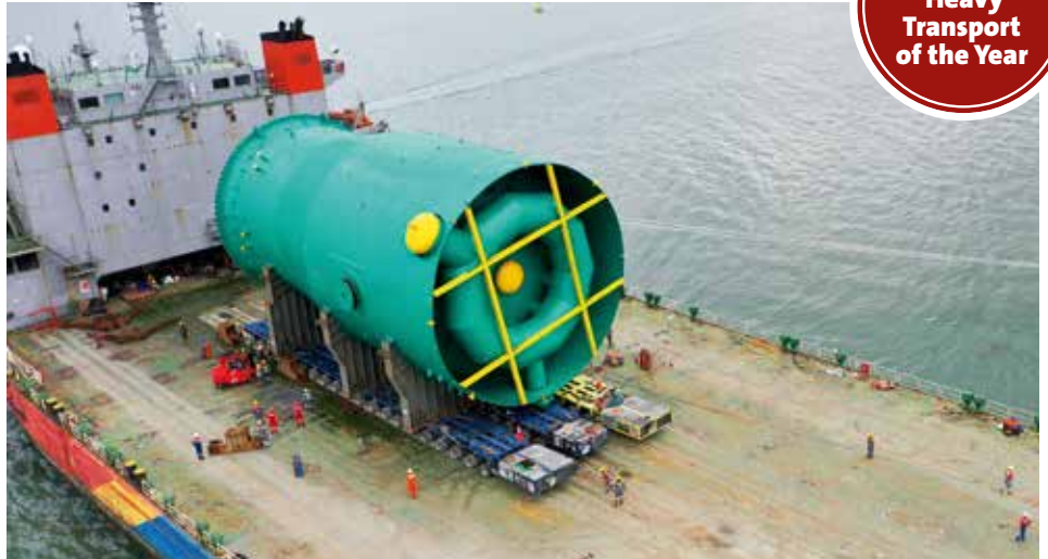
Transport des 1.357 t schweren Regenerators auf 3x20 PST/SL Achslinien.
