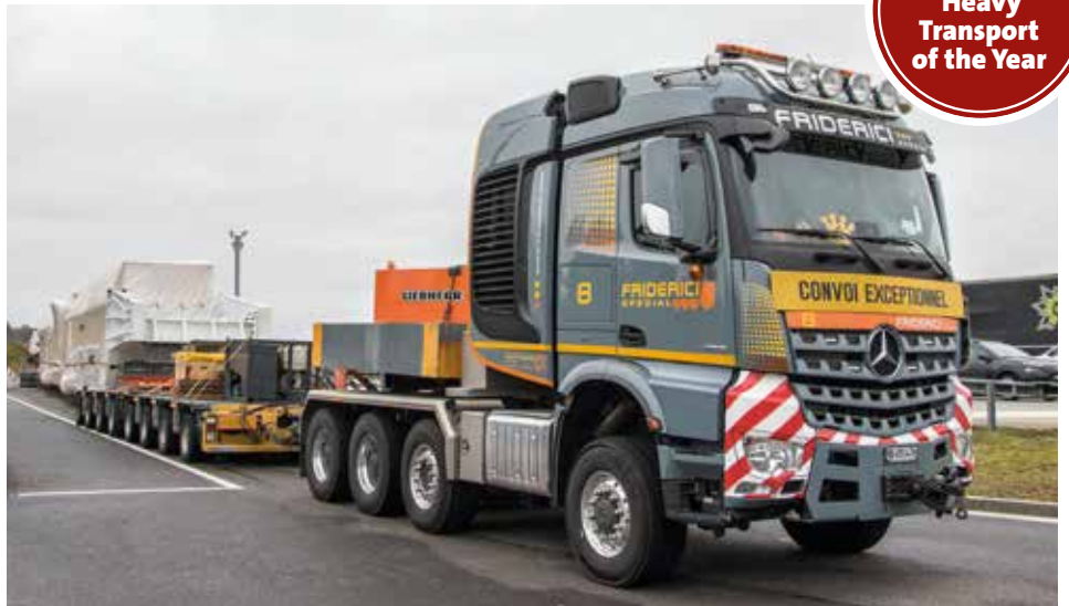
Transport des 1.357 t schweren Regenerators auf 3x20 PST/SL Achslinien.
