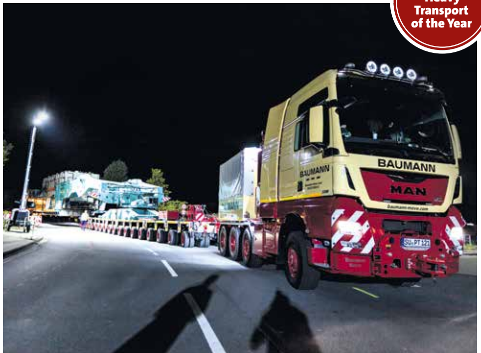
Auf dem ersten Teilstück der Strecke gab es für das lange Gespann – bestehend aus einem MAN TGX 41.640, der Scales-Scherenhub-Kesselbrücke auf zwei 18-achsigen Fahrwerken und einem weiteren MAN TGX 41.640 als Schubfahrzeug – genug Platz auf und neben der zweispurigen Straße.
