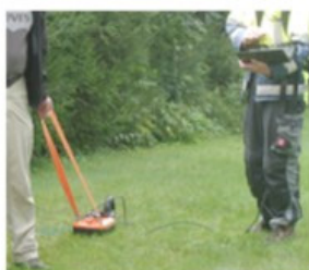
Bodenradar: elektromagnetische Impulse
