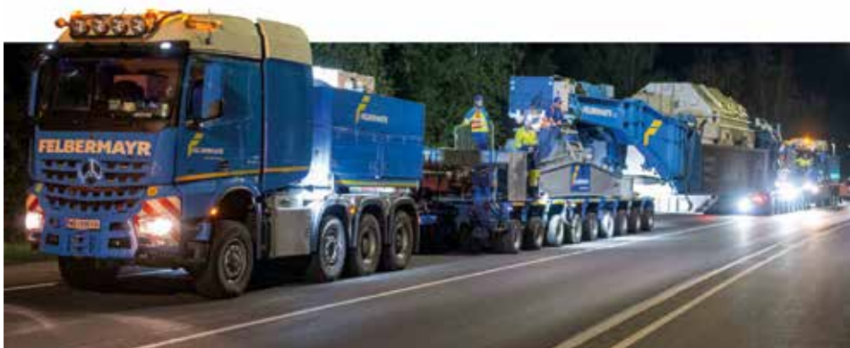
Felbermayr transportiert Großtrafos.
