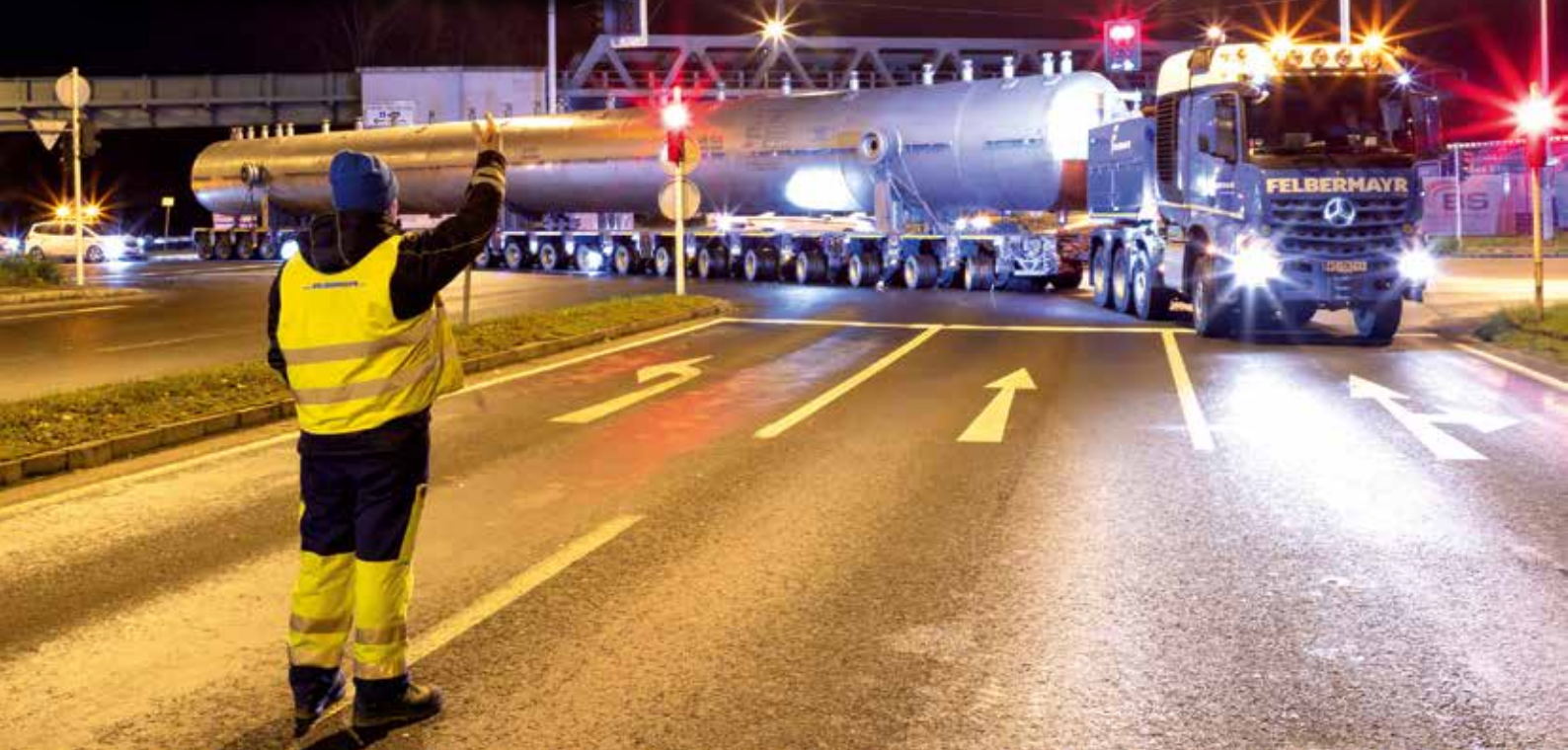
180 Tonnen auf 23 Achslinien des Felbermayr-Tiefloaders verteilt.
