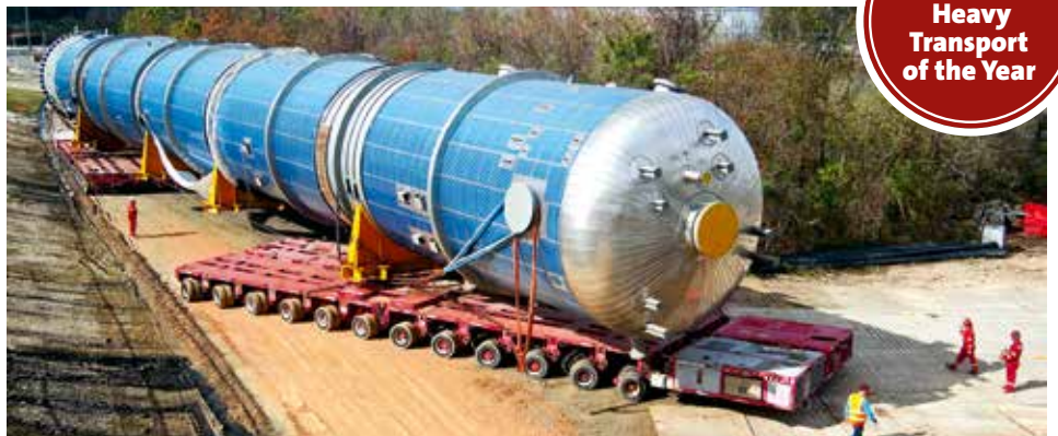
Über insgesamt 32 km transportierten die Schwerachslinien die großen Reaktorkessel.
