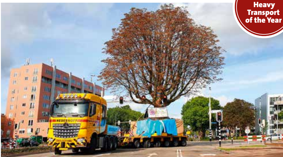
Während des Transports mussten Bordsteine überquert und Straßenlaternen sowie Ampelanlagen ausgewichen werden.
