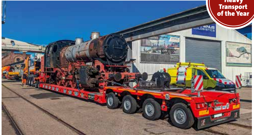
Die 60 Tonnen und 13,86 Meter lange Lokomotive auf dem 2+4 Tieflbett.
