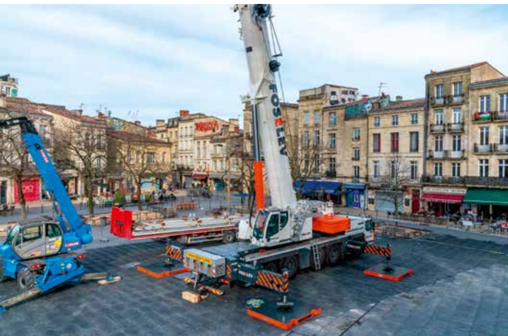
Voll abgestützt auf dem Vorplatz der Basilika zeigte der LTM 1250-5.1 von Foselev seine Stärke: Mit 41 Tonnen Ballast und einer 22 Meter langen, hydraulisch verstellbaren Doppelklappspitze erreichte der fabrikneue Mobilkran, von nur zwei Standorten aus, jede Stelle des gewaltigen Gerüsts.
