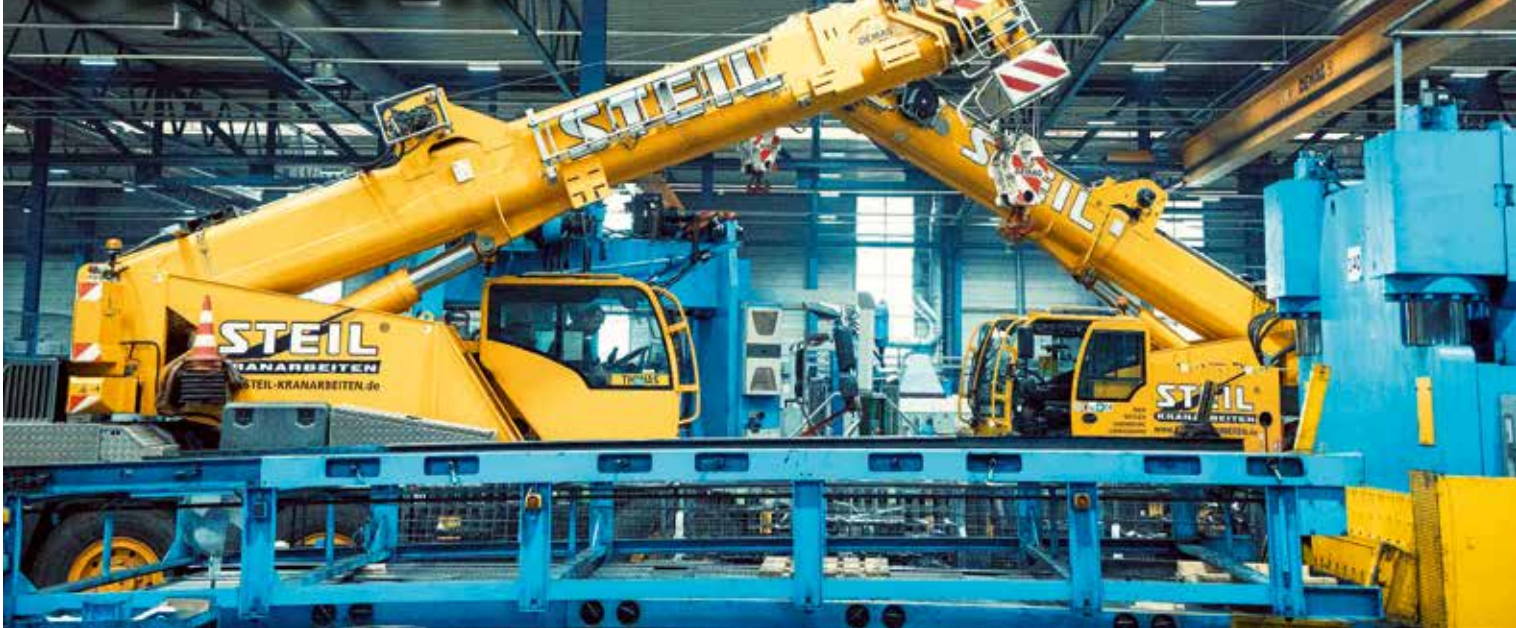
AC 3.045-1 City mit Allison 3500 SP Vollautomatikgetriebe.
