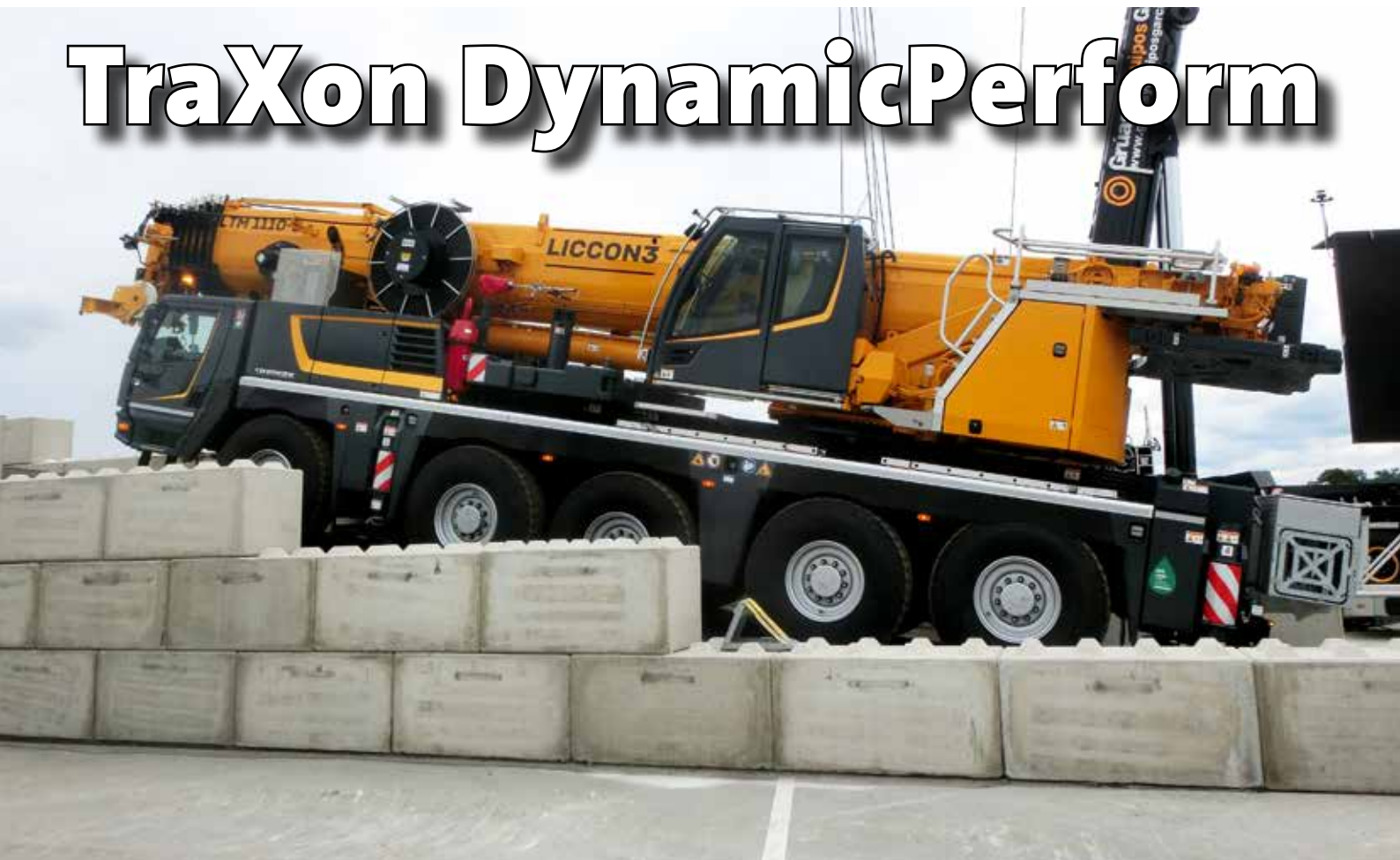
LTM 1110-5.2 im Kupplungs-Stresstest an einer 20 %-Rampe auf den Liebherr-Kundentagen im Juni 2024 in Ehingen.
